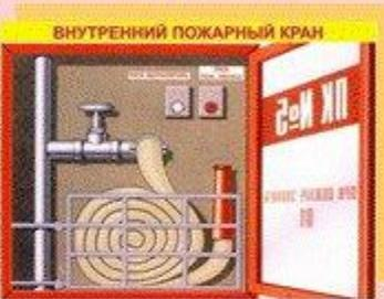
предназначен для тушения загораний различных объектов, кроме электроустановок под напряжением.
